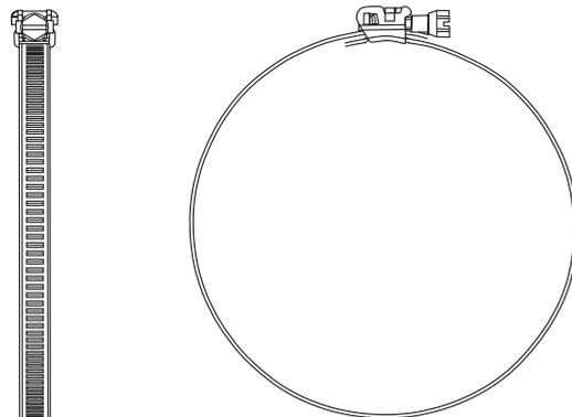
Der Kabelbinder dient zur Befestigung von Anlegetemperaturfühlern oder Hülsenfühler am Einsatzort.
